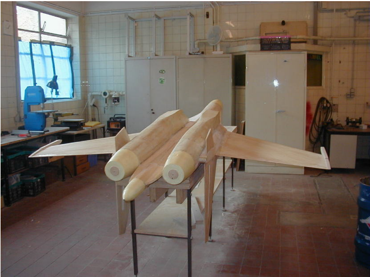
La structure en bois laisse apparaître nettement les formes de l'avion.
